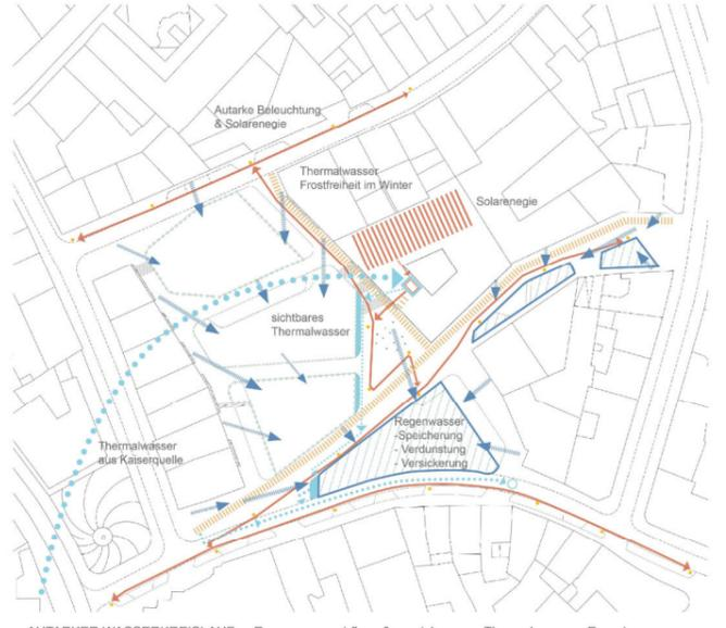
AUTARKER WASSERKREISLAUF - Regenwasserabfluss & -speicherung - Thermalwasser - Energie
