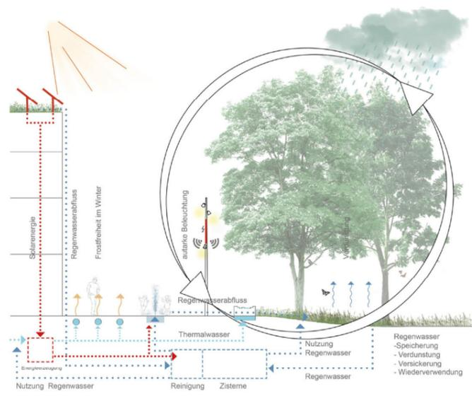
WASSERKREISLAUF - erlebbares Thermalwasser und erfahrbarer Wasserkreislauf Niederschlag
